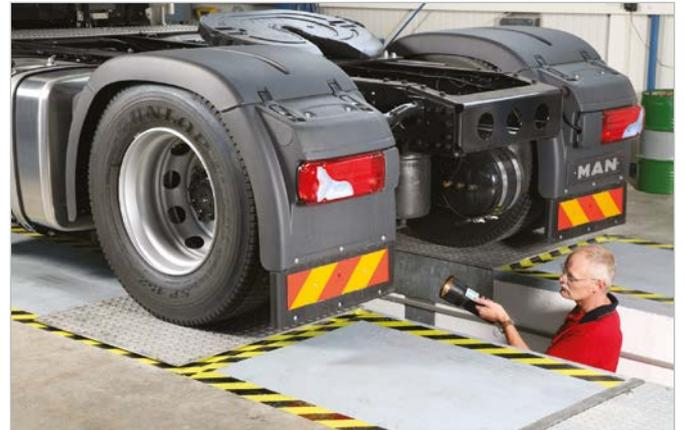
Der Gelenkspieltester JPD 4620 FA ist eine sinnvolle Ergänzung bei der Annahme oder Inspektion, um eine optische Kontrolle der Achsspiele vorzunehmen. Die verzinkten Prüfplatten werden mit Fingerdruck auf die Prüflampe hydraulisch bewegt. Die Prüfplatten sind einzeln, in gegenläufiger (4 Wege) oder in gleichlaufender Prüfrichtung (8 Wege) steuerbar.
