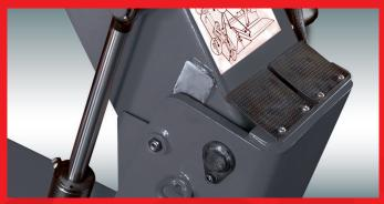
Spezialkonstruktion Einstellbare Druckbolzen verlängern die Lebensdauer des Spannfutterarmgelenks.
